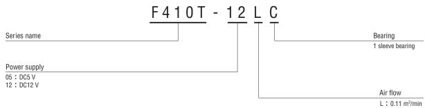
L: 0.11 m<sup>3</sup>/min M: 0.15 m<sup>3</sup>/min
