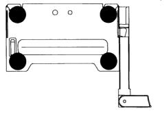
指示部(4 点)を同時に指で軽く押し、 イジェクターを嵌合させる。
