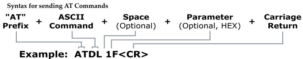
To read a parameter value stored in the RF module’s register, omit the parameter field.
