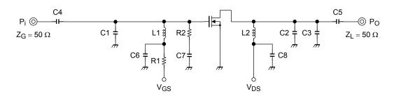
C1: 20 pF C2: 17 pF C3: 1 pF L1: φ0.6 mm enamel wire, 5.5ID, 5T L2: φ0.6 mm enamel wire, 5.5ID, 7T R1: 6.8 kΩ R2: 56 Ω
