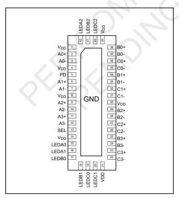
Pin Configuration (42-TQFN ZL, Top-Side View)
