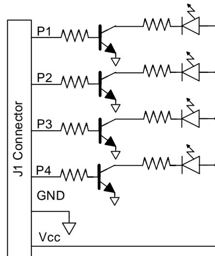
**LED Module Circuit Diagram**
