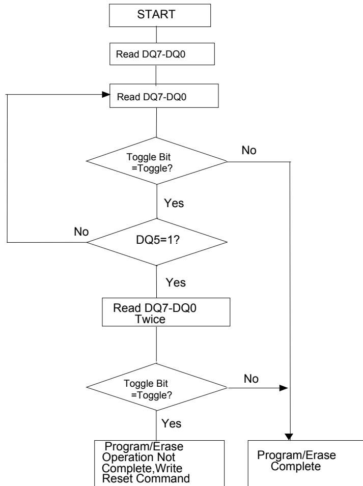
**Note:** The system should recheck the toggle bit even if DQ5 = "1" because the toggle bit may stop toggling as DQ5 changes to "1". See DQ6 and DQ2 section for more information
