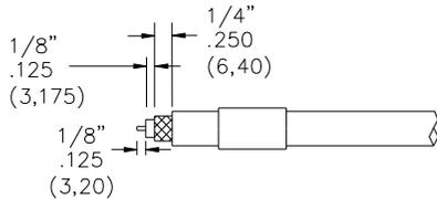
3. STRIP CABLE JACKET, BRAID, AND DIELECTRIC TO SPECIFICATION LENGTHS. (NOTE: FOIL AND BRAID CABLES SHOULD LEAVE FOIL TO END OF DIELECTRIC).
