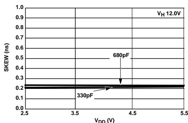
FIGURE 30. tSkewF vs V<sub>DD</sub>
