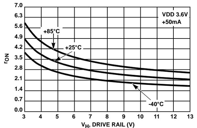
FIGURE 4. DRIVER  $r_{ON}$  vs  $V_H$  SINK RESISTANCE
