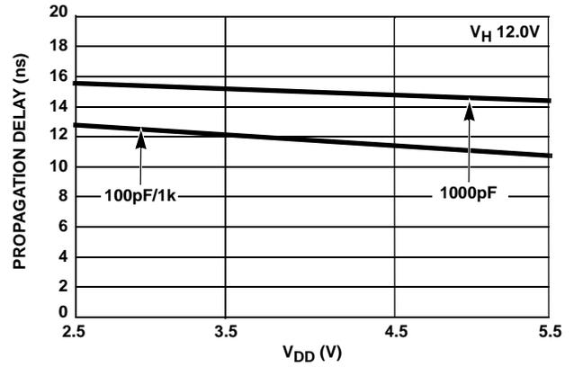
FIGURE 24. tpdF vs V<sub>DD</sub>
