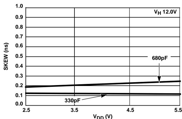
FIGURE 29. tSkewR vs V<sub>DD</sub>
