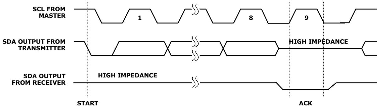
FIGURE 14. ACKNOWLEDGE RESPONSE FROM RECEIVER
