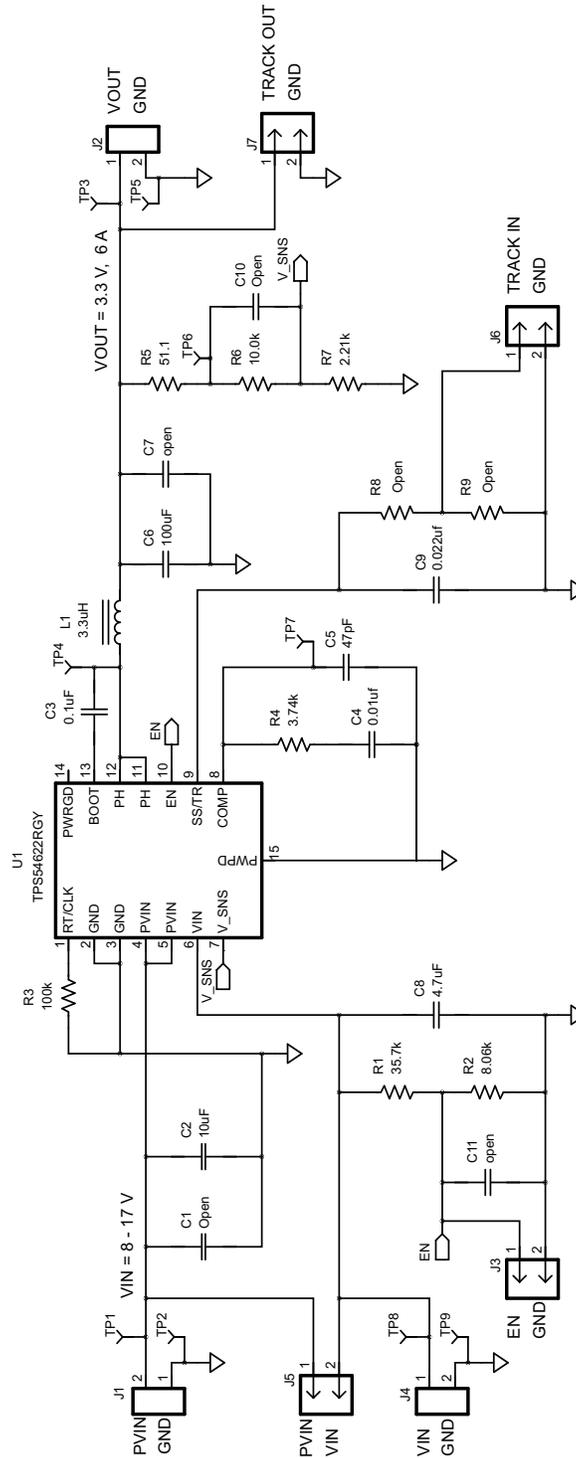
Figure 18. TPS54622EVM-012 Schematic
