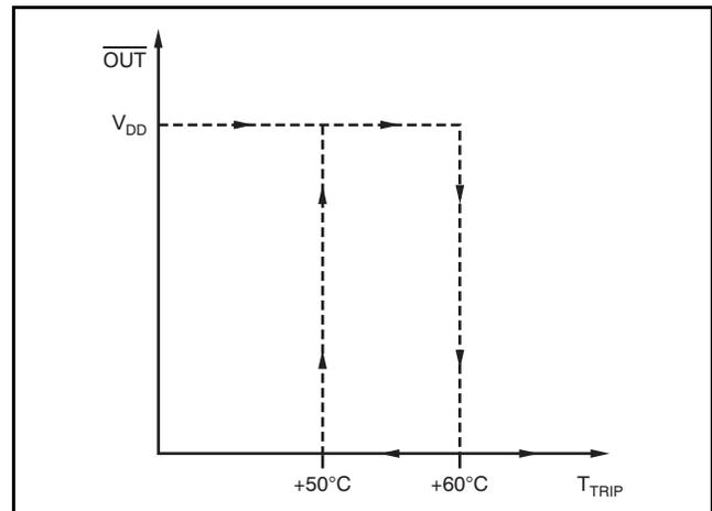
**Figure 9. TMP302A; HYST<sub>SET</sub> = V<sub>S</sub>; TRIP<sub>SET1</sub> = V<sub>S</sub>, TRIP<sub>SET0</sub> = GND**
