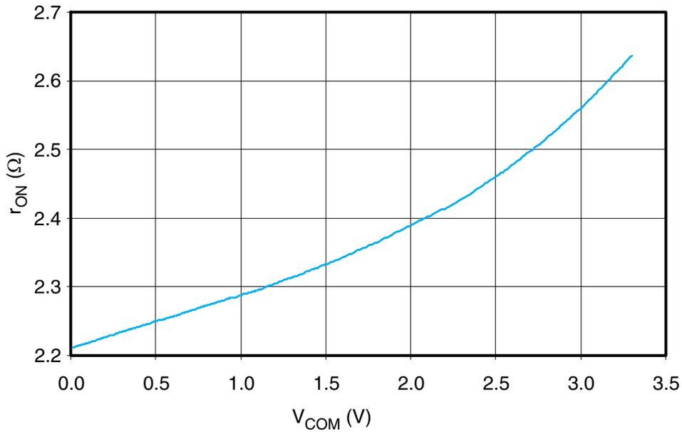
Figure 4. r<sub>ON</sub>(Ω) vs V<sub>COM</sub>(V)
